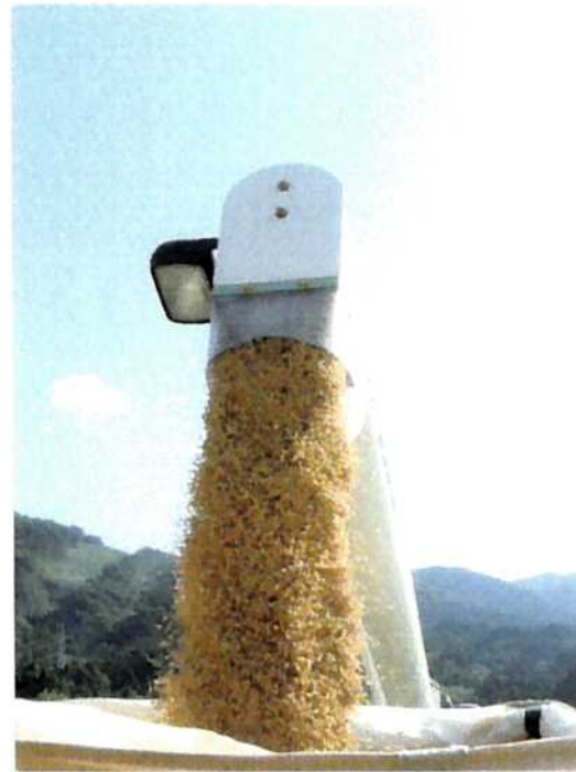
収穫の秋。刈り取られた 稲は、コンバインの中で、もみと わらに分けられます。細かく 切られたわらは、田んぼへ 返します。
